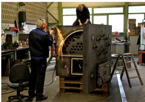
Eine Brennkammer in der eigenen Schlosserei
